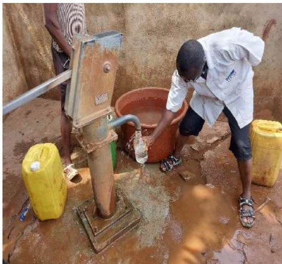
Photo 2 : Echantillonnage et mesure in situ de paramètres physico-chimiques d'eau de forage à Toubalo
