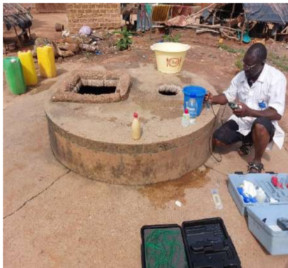
Photo 3 : Echantillonnage et mesure in situ de paramètres physico-chimiques d'eau de puits à Kongasso
