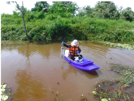
เก็บตัวอย่างน้ำผิวดินแบบจ้วงตัก ด้วยกระบอกรว Water Sampler ที่กึ่งกลางลำคลอง
