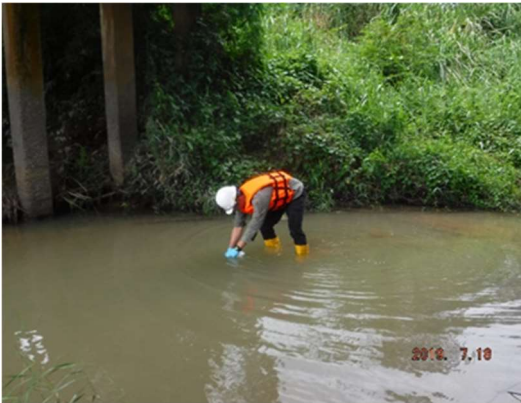
เก็บตัวอย่างน้ำแบบจ้วงตัก (Grab Sampling) ที่กึ่งกลางลำคลอง
