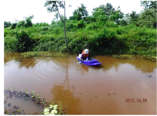
เก็บตัวอย่างน้ำสำหรับดัชนีน้ำมันและไขมันบริเวณผิวน้ำ (Surface Sampling)
