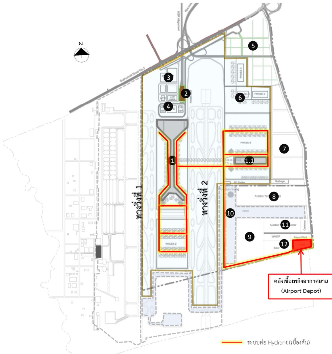
รูปที่ 2.5-2 แนวคิดเบื้องต้นการวางระบบท่อ Hydrant สำหรับงานให้บริการเติมเชื้อเพลิงอากาศยาน
